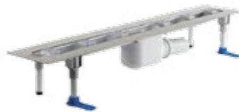
DUSCHRINNE aus Edelstahl, Länge: 500 – 2.000 mm, Breite: 40 mm, Bauhöhe: 110 mm, Ablaufleistung: 48 – 84 l/min
