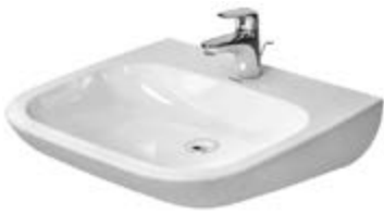
UNTERFAHRBARER WASCHTISCH aus Sanitärkeramik, Breite: 600 mm, Höhe: 155 mm, Tiefe: 550 mm, mit Hahnloch
