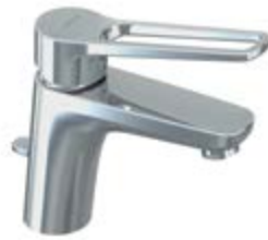
WASCHTISCHARMATUR aus Messing / verchromt, Höhe: 175 mm, Auslaufhöhe: 90 mm, Ausladung: 145 mm
