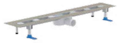
DUSCHRINNE aus Edelstahl, Länge: 500 – 2.000 mm, Breite: 40 mm, Bauhöhe: 68 mm, Ablaufleistung: 27,6 – 49,2 l/min
