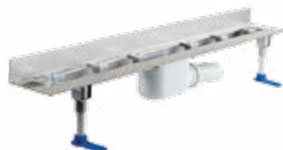
DUSCHRINNE aus Edelstahl, Länge: 500 – 2.000 mm, Breite: 40 mm, Bauhöhe: 110 mm, Ablaufleistung: 48 – 84 l/min
