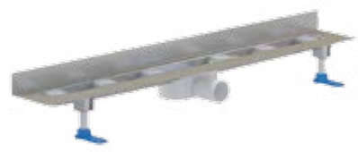
DUSCHRINNE aus Edelstahl, Länge: 500 – 2.000 mm, Breite: 40 mm, Bauhöhe: 68 mm, Ablaufleistung: 27,6 – 49,2 l/min
