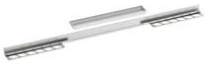
DUSCHRINNE CERAWALL INDIVIDUAL aus Edelstahl, Länge: 800 - 1.500 mm, Breite: 60,5 mm, Ablaufleistung: 30 - 141 l/min
