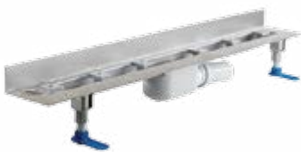
DUSCHRINNE aus Edelstahl, Länge: 500 – 2.000 mm, Breite: 40 mm, Bauhöhe: 90 mm, Ablaufleistung: 42 – 72 l/min
