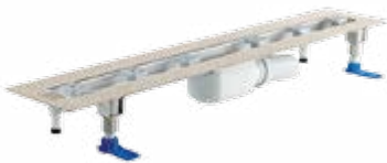
DUSCHRINNE aus Edelstahl, Länge: 500 – 2.000 mm, Breite: 40 mm, Bauhöhe: 90 mm, Ablaufleistung: 42 – 72 l/min
